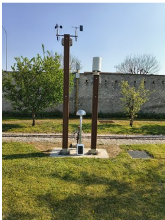
La strumentazione del MeteoLab: La stazione Quido, il fulminometro e il nuovo rilevatore per la grandine donato da Nesa.
