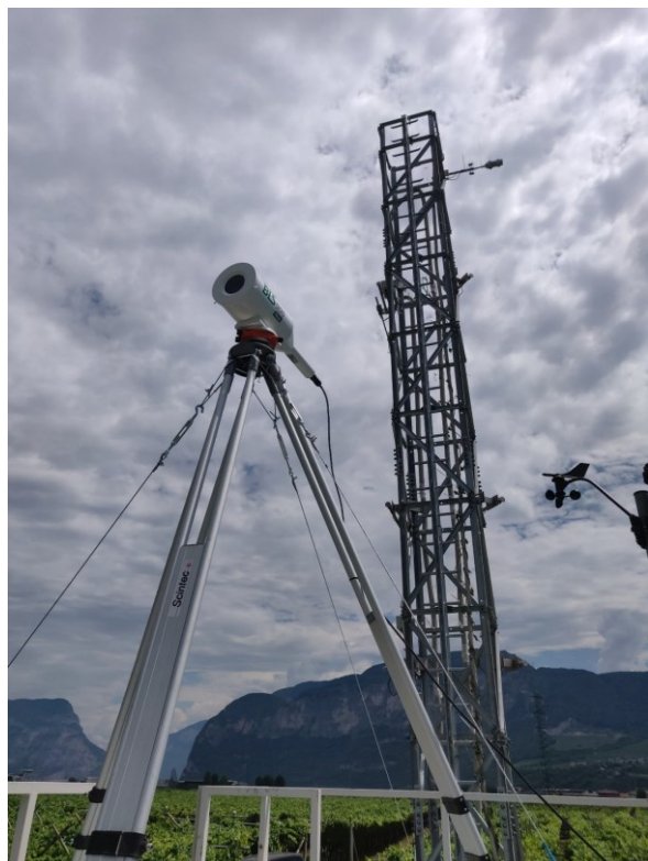
Scintillometro installato presso la torre eddy-covariance di Mezzolombardo per il progetto INTERFACE durante l'estate 2025.
