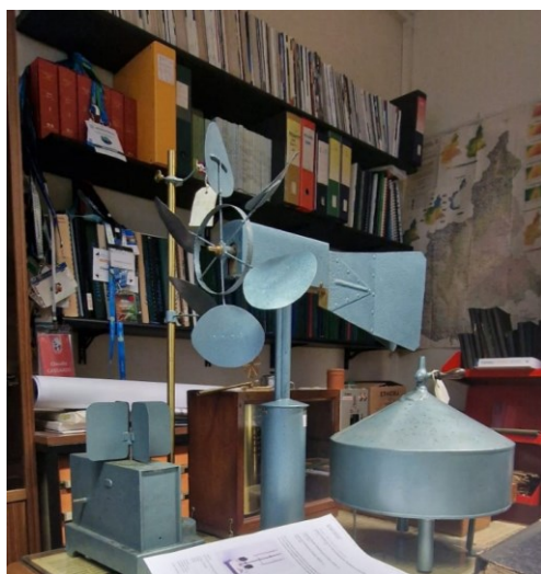
Componenti dell'anemografo e del pluviografo ora conservati nel Museo del Dipartimento di Fisica
