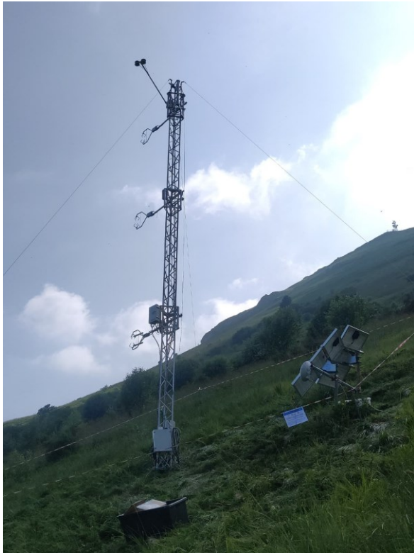
Torre eddy-covariance installata lungo il pendio sul Monte Baldo nell'ambito del progetto DECIPHER.
