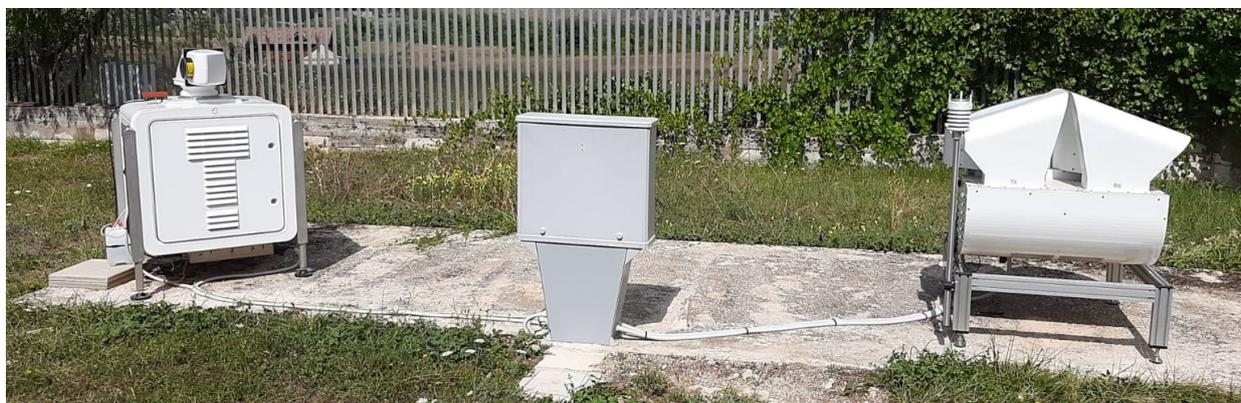
Figura 1: Il Doppler Cloud radar (a destra) e (a sinistra) il Wind Lidar.
