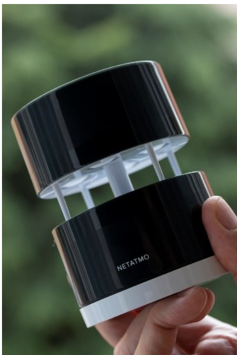
Figura 1. Un esempio di anemometro ultrasonico 2D "amatoriale": ormai non è l'unico...
