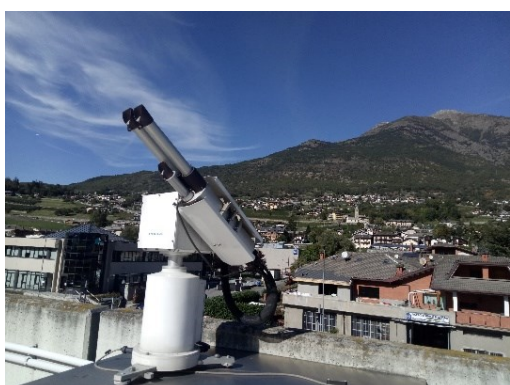
Fotometro per il telerilevamento delle proprietà dell'aerosol
