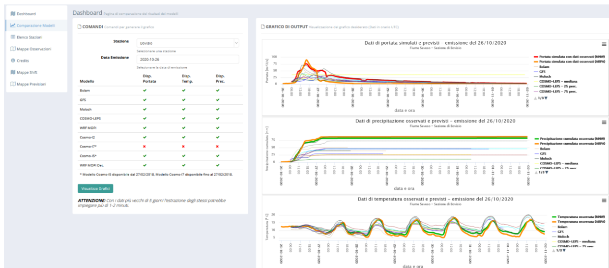
Figura 3. Pagina di approfondimento di un evento idro-meteorologico che mostra l'analisi multi-model per la sezione di Bovio Masciago.
